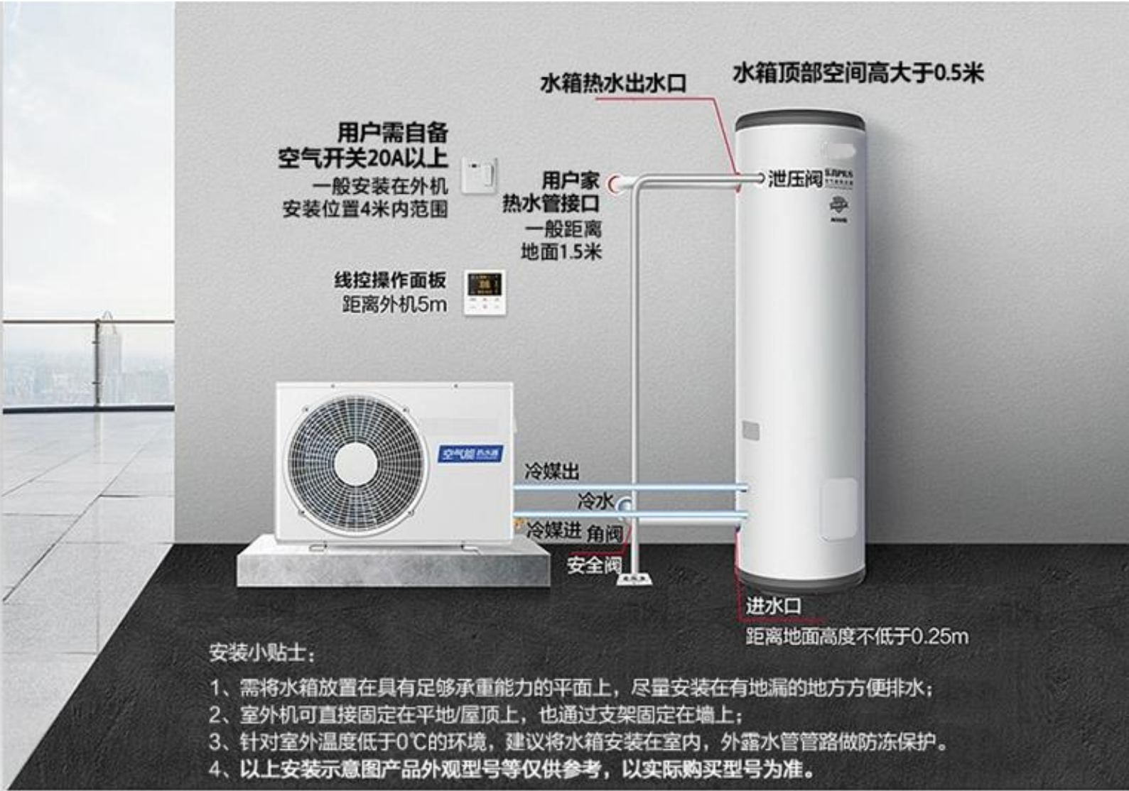
空气源热泵热水系统安装示意图
