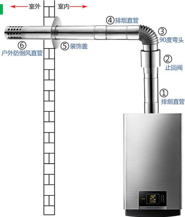
燃气热水器排烟管安装示意
